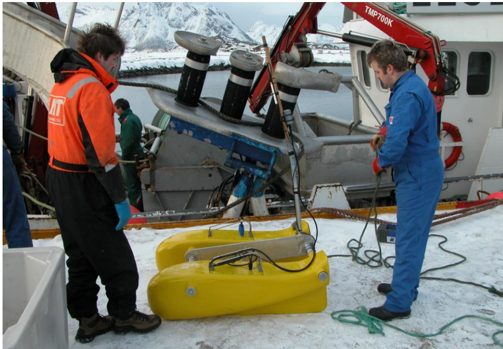
Figur 1. Testing av Videofarkost (slepeparavan) før sjøsetting. Slepeparavan er i helhet utviklet ved FG Fangst, Havforskningsinstituttet. (M/S "Ingo").
