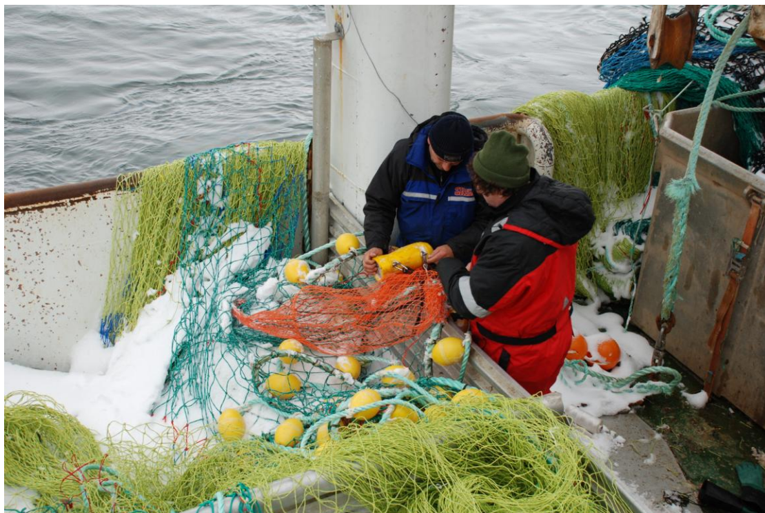
Figur 3. Montering av Simrad's hovedsensor for geometri på snurrevadens kuletelne. (M/S "Kildin")
